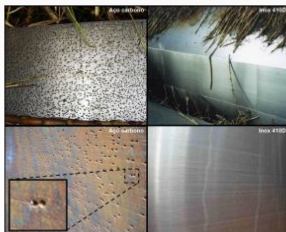
Fig. 2 - Lateral do esteirão de cana quando aplicado aço carbono e o inox 410D
