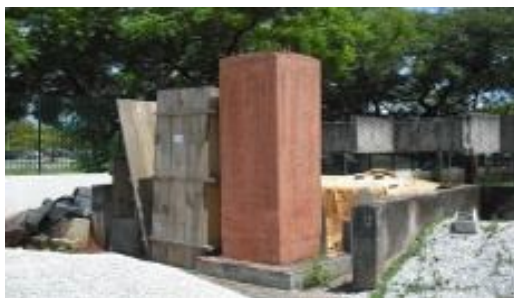
Pilar utilizado no trabalho ficou de 2002 a 2010 ao ar livre na Poli
